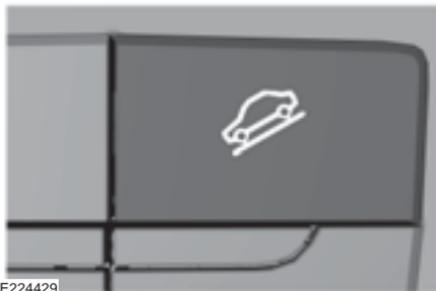
Presione el botón de asistencia de arranque en pendientes para activar la asistencia de arranque en pendientes. La luz de asistencia de arranque en pendientes aparece en el tablero de instrumentos cuando el sistema está activo. Presione el botón nuevamente para apagar el sistema.
