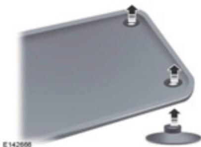
Para instalar las alfombras de piso, colóquelas de manera que el ojal quede sobre el pin de sujeción y presione hacia abajo para asegurarlas.
