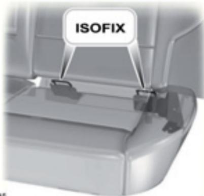
2. Empuje firmemente el asiento del niño para atrás para fijar los puntos de anclaje inferiores de ISOFIX.
