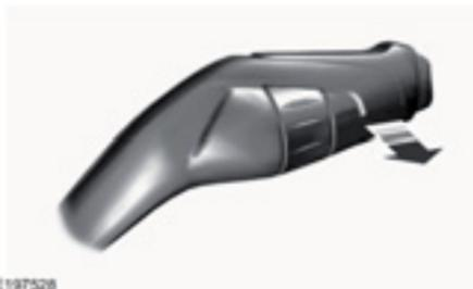
Para usar el lavaparabrisas, tire de la palanca hacia usted. Al soltar la palanca, el limpiaparabrisas funcionará por un breve periodo.
