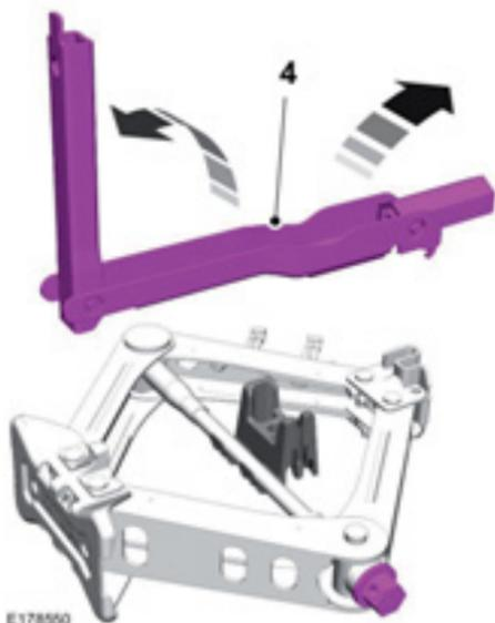
4. Despliegue la manija del crique y el extremo hexagonal hasta alcanzar la posición correcta antes del uso. Use el extremo hexagonal para hacer girar el tornillo del crique y para sacar las tuercas de rueda.
