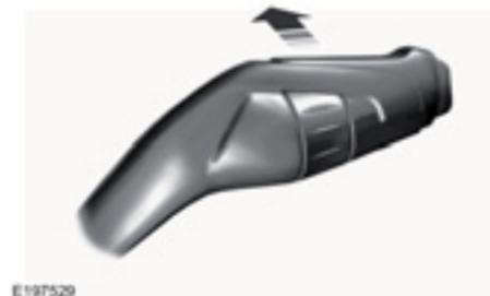
Mueva la palanca alejándola de usted para hacer funcionar el lavaluneta. Cuando suelta la palanca, el limpiador sigue funcionando por un breve período.
