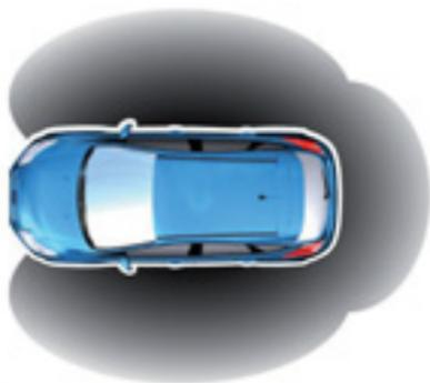
Para trabar y destrabar las puertas de forma pasiva debe haber una llave pasiva válida dentro de una de las tres áreas de detección externas. Estas están ubicadas aproximadamente a 1,5 m de las manijas de las puertas delanteras y del portón trasero.
