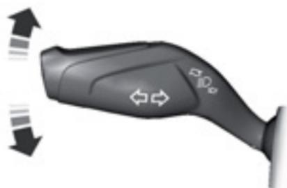
Levante o baje la palanca para usar las luces de giro.
