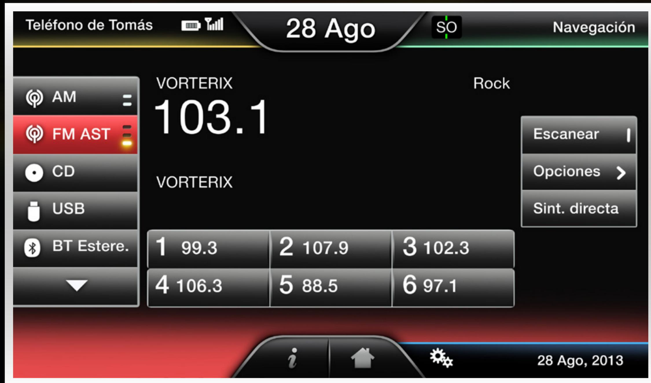
El sistema permite seleccionar diferentes fuentes (Radio AM/FM, CD, Bluetooth®, USB y tarjeta SD) a través de la pantalla táctil.
