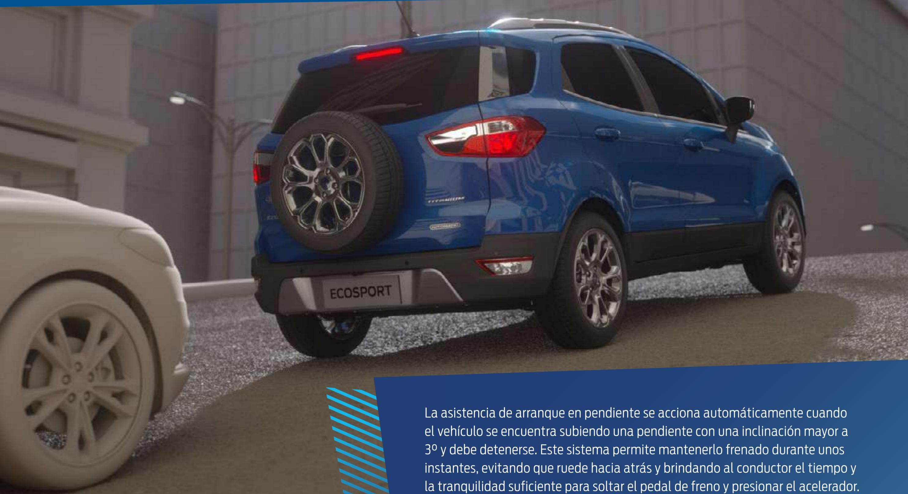
La asistencia de arranque en pendiente se acciona automáticamente cuando el vehículo se encuentra subiendo una pendiente con una inclinación mayor a 3° y debe detenerse. Este sistema permite mantenerlo frenado durante unos instantes, evitando que ruede hacia atrás y brindando al conductor el tiempo y la tranquilidad suficiente para soltar el pedal de freno y presionar el acelerador.
