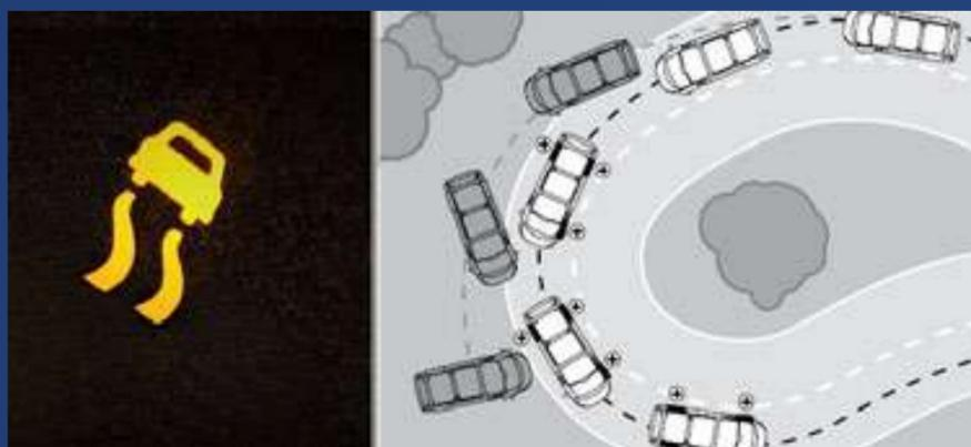
El Control Electrónico de Estabilidad (ESC) es el encargado de monitorear de forma continua la trayectoria del vehículo a través de sensores de velocidad ubicados en las ruedas delanteras y traseras, y la compara con el recorrido trazado por el conductor. En caso de riesgo, el sistema controla los frenos para regular la presión que llega a cada rueda, y reduce la potencia del motor hasta que la situación se normalice.
