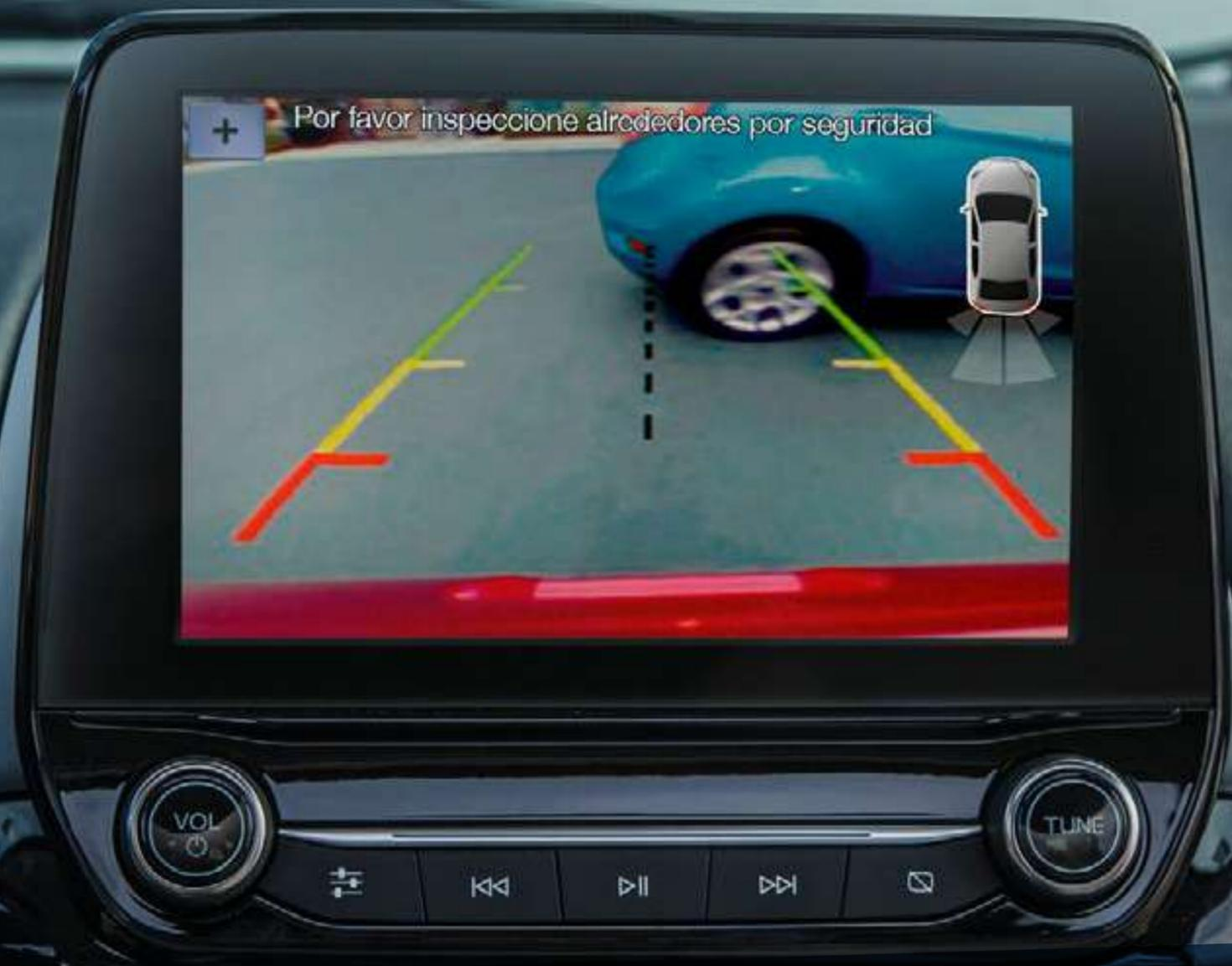
Al colocar marcha atrás, la cámara ubicada en la parte trasera de la Ecosport mostrará, en la pantalla central multi-táctil flotante de 8", todo lo que se encuentre detrás del vehículo. Esto le permitirá al conductor realizar las maniobras con mayor control y seguridad.
