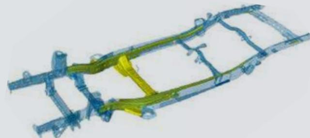
La columna vertebral de la robustez y de la enorme capacidad de Ranger se encuentra en el chasis reforzado de perfil cerrado de acero de mayor espesor, altamente resistente y flexible a la vez. Las cavidades inyectadas con cera, los adhesivos anticorrosivos y los extremos sellados con PVC aseguran la durabilidad de su robustez y elasticidad.
