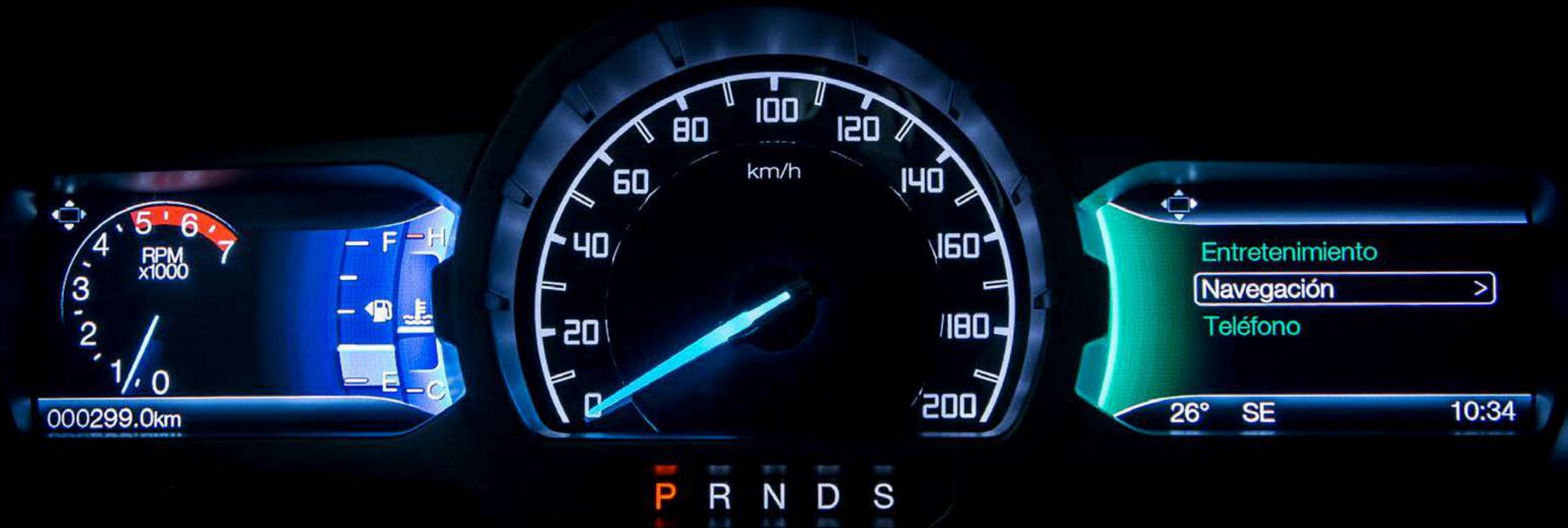
Dos pantallas LCD de 4,2" permiten visualizar y controlar los diferentes sistemas del vehículo sin necesidad de quitar las manos del volante.
