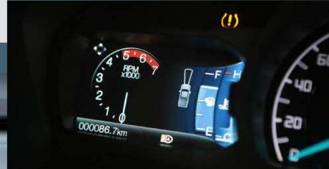
El TPMS evalúa la presión de los neumáticos a través de sensores ubicados en las válvulas y emite una luz de advertencia en el panel de instrumentos visible para el conductor, en caso de que algún neumático sufra una baja de presión.
