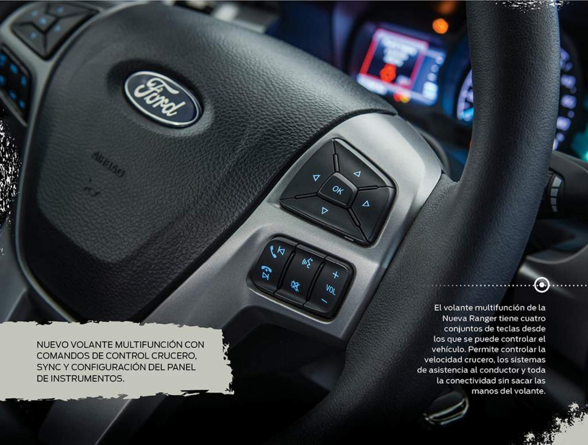
NUEVO VOLANTE MULTIFUNCIÓN CON COMANDOS DE CONTROL CRUCERO, SYNC Y CONFIGURACIÓN DEL PANEL DE INSTRUMENTOS.
