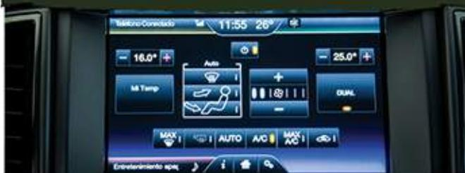
Permite controlar la calefacción y refrigeración indicando las temperaturas, la velocidad del ventilador y las salidas de aire deseadas, con la posibilidad de configurar diferentes valores para el conductor y el acompañante. Puede regularse mediante el Sistema de Control por Voz, a través de la pantalla de SYNC My Ford Touch y desde los comandos digitales.
