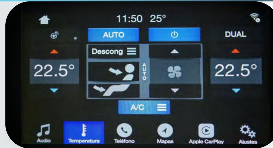
A través de la pantalla táctil puedes fijar la temperatura deseada, ajustar la intensidad de ventilación, establecer la dirección del flujo de aire, encender o apagar el aire acondicionado, activar o desactivar el modo dual el cual habilita la configuración de temperatura diferenciada del conductor y el acompañante.
