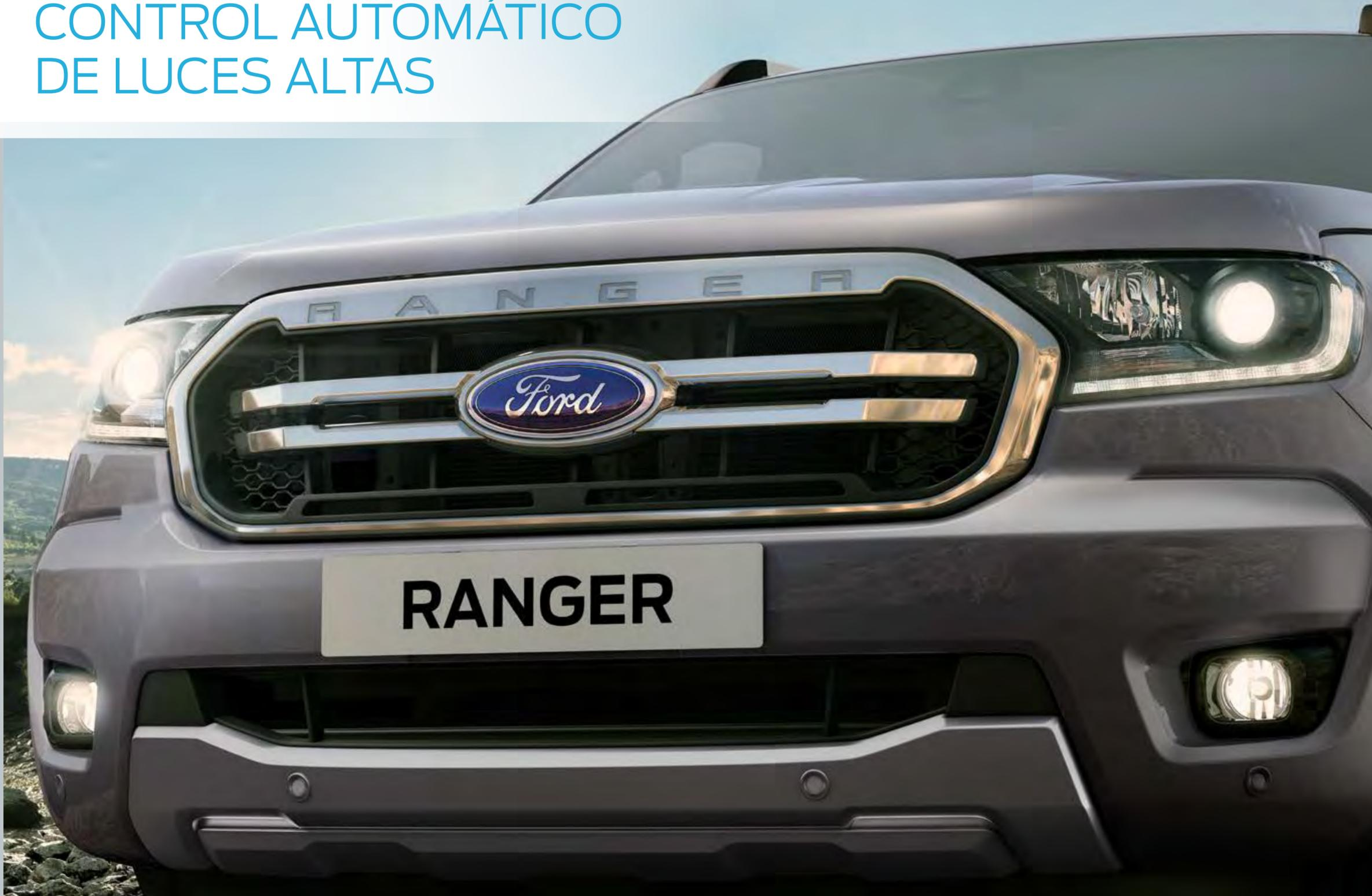
Las luces altas se activan para brindar máxima visibilidad, y se desactivan automáticamente cuando viene otro vehículo de frente.
