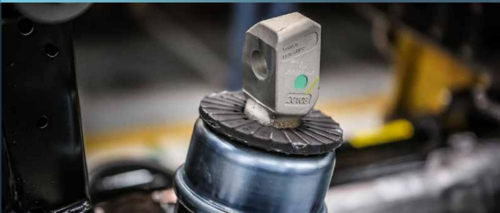
Reducen los niveles de vibraciones del motor en el arranque y la parada. Mejoran el confort en la conducción y reducen el temblor causado por las imperfecciones del camino.
