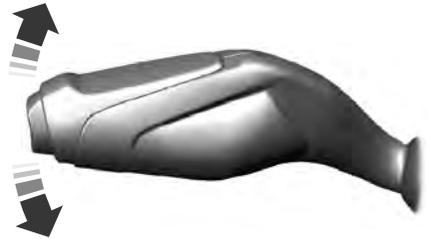
Levante o baje la palanca para encender las luces de giro.
