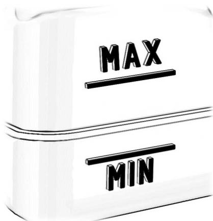
Si el nivel de fluido de la dirección hidráulica está por debajo de la marca **MAX**, agregue un fluido de la dirección hidráulica que cumpla con las especificaciones correctas.
