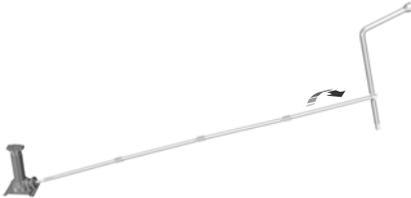
1. Ensamble la palanca del crique.
