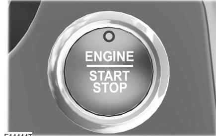
Presione el botón de arranque una vez sin colocar el pie sobre el pedal del freno ni del embrague. Este botón se encuentra en el panel de instrumentos, cerca del volante de dirección. Todos los circuitos eléctricos y los accesorios están en condiciones de funcionar, y se encienden las luces e indicadores de advertencia.
