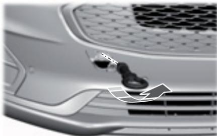
1. Retire suavemente la cubierta de la punta del gancho de remolque frontal y trasero.
