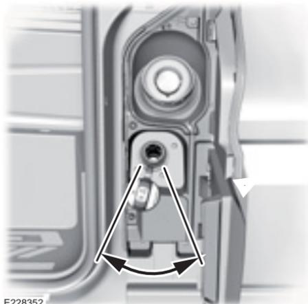
Opere la boquilla de la bomba del líquido de escape diésel (AdBlue) dentro de la zona que se muestra.
