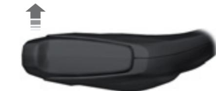
Empuje la palanca alejándola de usted para encender las luces altas.
