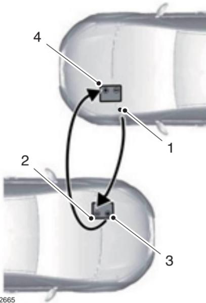
1. Retire el cable pasacorriente negativo (-) del vehículo descompuesto.
