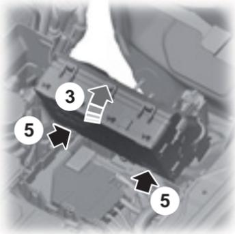
3. Mueva la caja de fusibles hacia la parte trasera del compartimento del motor y gírela como se muestra en el gráfico.
