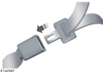
1. Coloque la lengüeta del cinturón en la hebilla correspondiente (la hebilla más cercana a la dirección de la lengüeta) hasta escuchar un chasquido y sentir que está abrochado. Asegúrese de que la lengüeta esté sujeta firmemente en la hebilla.
