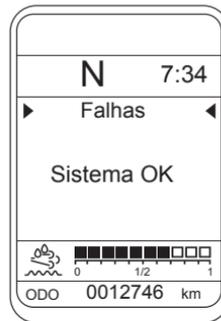
Si en la parte superior, donde está la información de la transmisión "N", hubiera una "F", indica que existe una falla en la transmisión.
