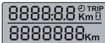
El visor informa el kilometraje total, kilometraje parcial, reloj y horímetro / horómetro.
