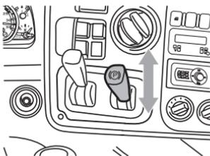
En condiciones de emergencia en que el vehículo no tenga suficiente aire en el sistema de frenos para accionar el freno de servicio, el freno de estacionamiento puede ser utilizado como freno de emergencia.
