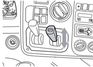
Si la presión de la línea de freno cae debido a una falla, el freno de estacionamiento podrá ser utilizado gradualmente en situaciones de emergencia, a través de la palanca en el panel.
