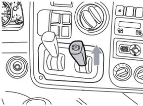
El freno de estacionamiento posee la característica de poder ser aplicado o desaplicado gradualmente, proporcionando al conductor confort y seguridad cada vez que inicie el movimiento del vehículo en pendientes.
