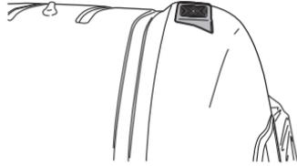
1. Suelte los dos tornillos de fijación y retire el cuerpo del faro.
