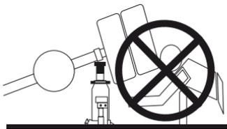
Utilice el crique solamente para cambio de ruedas. Nunca trabaje debajo de un vehículo apenas apoyado por el crique.
