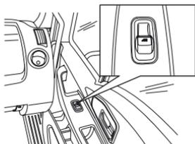
Accione el interruptor hacia arriba con un toque rápido, para el cierre total del vidrio.
