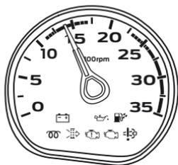
El tacómetro está dividido en franjas operacionales, las cuales identifican el régimen en que el motor está operando, indicando las revoluciones por minuto (rpm) del motor.
