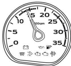
Para emisiones de NOx superiores a los 3,5 g/kWh el sistema de autodiagnóstico a bordo – OBD encenderá la LIM. Luego de 36 horas consecutivas de funcionamiento del motor, si la falla que ocasionó el aumento de emisión de NOx no fue resuelta, el vehículo entrará en modo de reducción de torque del motor.
