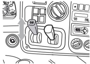
El uso del mismo en pendientes, principalmente en pisos de poca adherencia, garantiza la alineación del conjunto camión/semirremolque/ acoplado evitando así el efecto "L" (o tijera) del semirremolque/acoplado.
