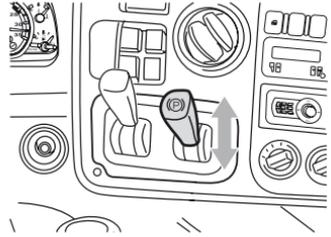
Si la presión de la línea de freno cae debido a una falla, el freno de estacionamiento podrá ser utilizado gradualmente en situaciones de emergencia, a través de la palanca en el panel.
