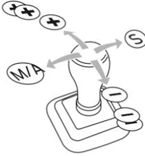
Para cambiar del modo automático al manual y viceversa es necesario mover la palanca hacia la izquierda.
