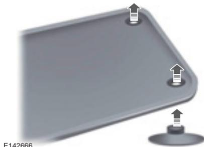
Para instalar las alfombras de piso, colóquelas de manera que el ojal quede sobre el pin de sujeción y presione hacia abajo para asegurarlas.
