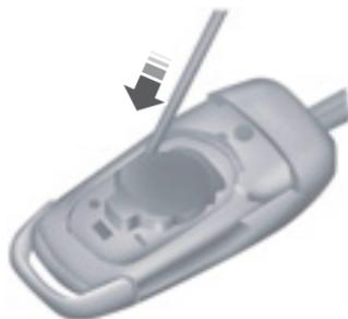
**Nota:** No toque los contactos de la pila ni la tarjeta de circuito impreso con el destornillador.
