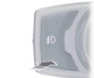
Presione el control para encender o apagar los faros antiniebla.
