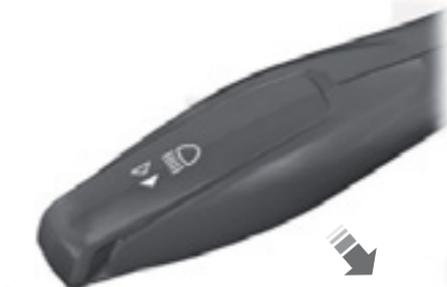
Tire de la palanca por completo hacia usted para encender las luces altas.
