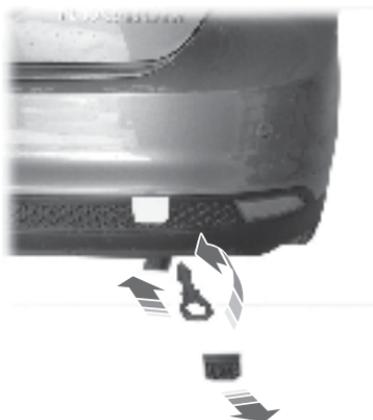
Inserte un objeto adecuado en el orificio de la parte inferior de la cubierta y retire la cubierta haciendo palanca.
