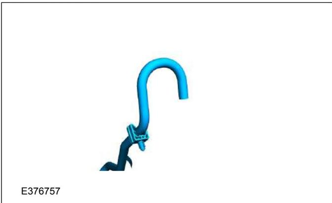
**Ejemplo de ubicación de montaje del tubo de ventilación del depósito de combustible**
